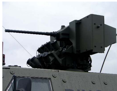
Дистанциона оружна станица ROSS RWS 12,7 mm, БДК 8x76 mm на белгијском „динго“
